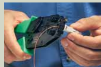
Crimpeado del Conector
