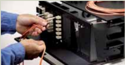
Conectar el Patch Cord y/o Sistema Modular
